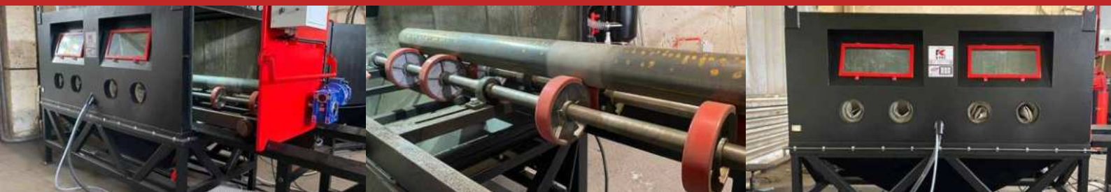
Камера с выдвижным поворотным столом справа и слева
