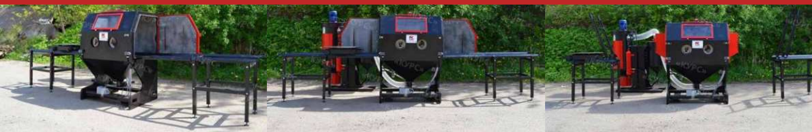
Камера с электроприводом, системой фильтрации и рекуперации абразива
