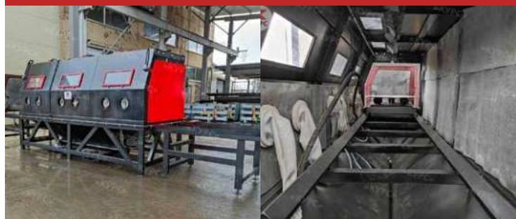
Камера с предкамерой для длинномеров, фильтром с рекуператором
