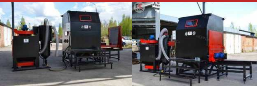
Камера с предкамерой для длинномеров, фильтром с рекуператором
